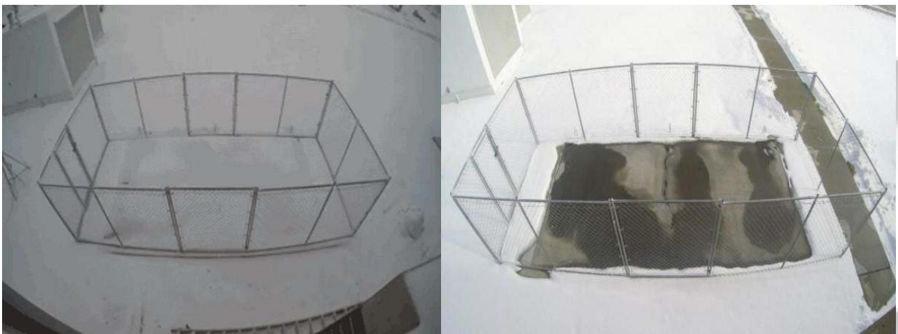
從上圖可見，接通電源後，石屎上的冰雪便被融掉。
